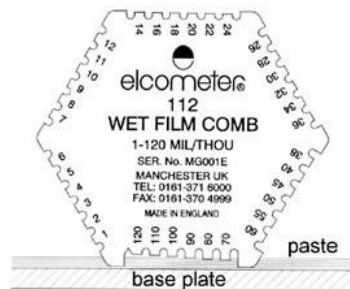
Рисунок 26. Гребешок для измерения толщины теплопроводящей пасты.
