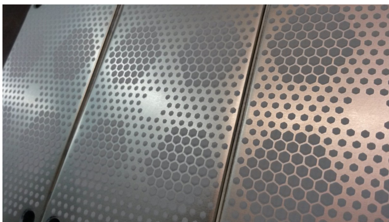
Рисунок 27. РСМ нанесенный на модули MIAA при помощи трафарета.
