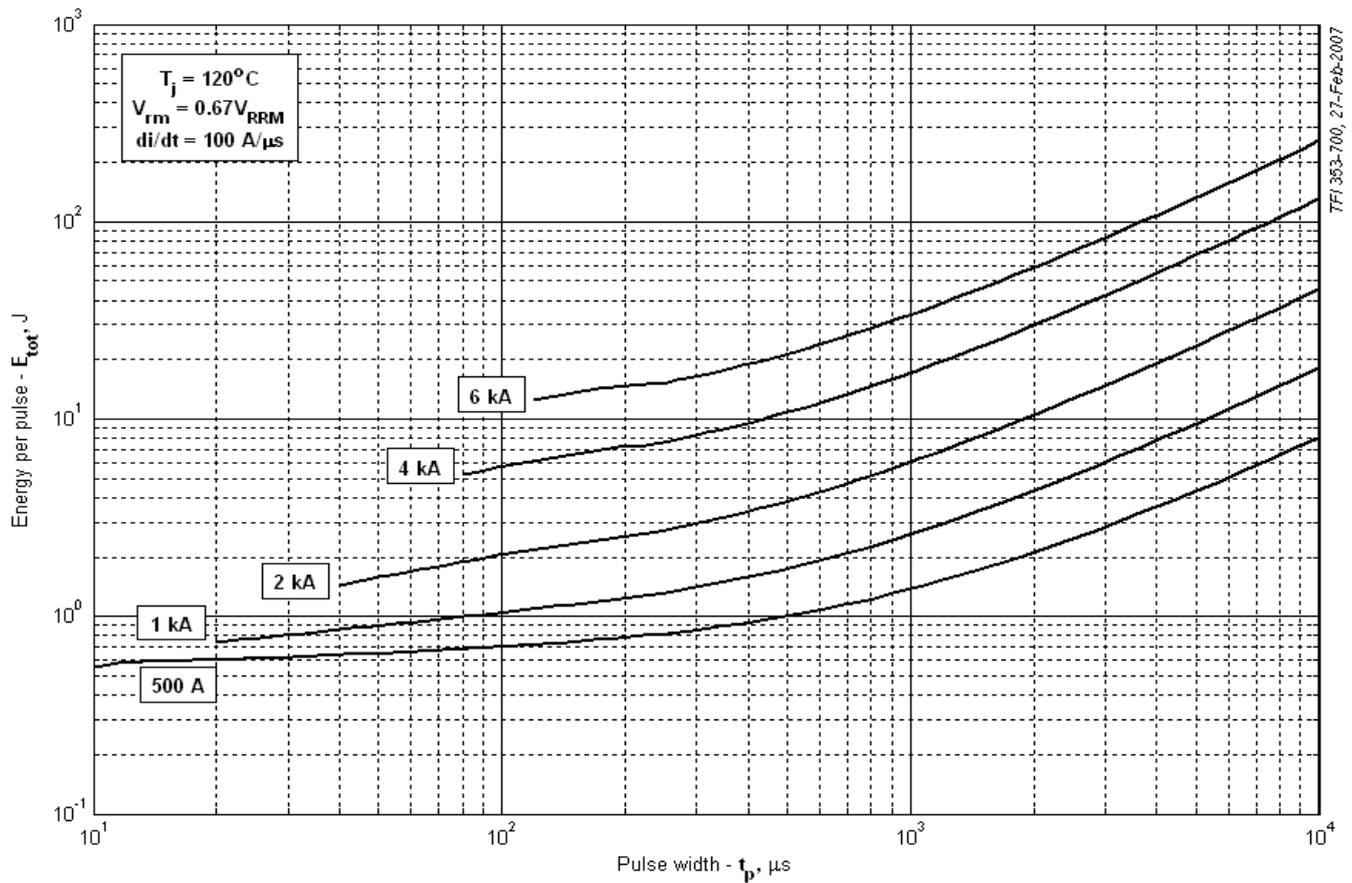
Рис. 26 – Суммарная энергия потерь одного прямоугольного импульса тока
