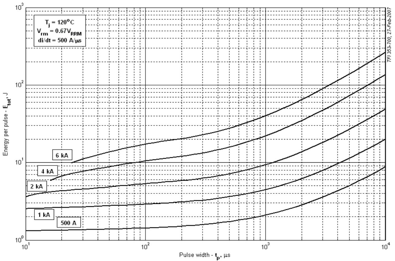
Рис. 27 – Суммарная энергия потерь одного прямоугольного импульса тока
