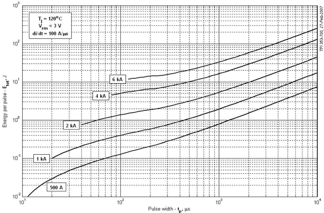
Рис. 20 – Суммарная энергия потерь одного прямоугольного импульса тока
