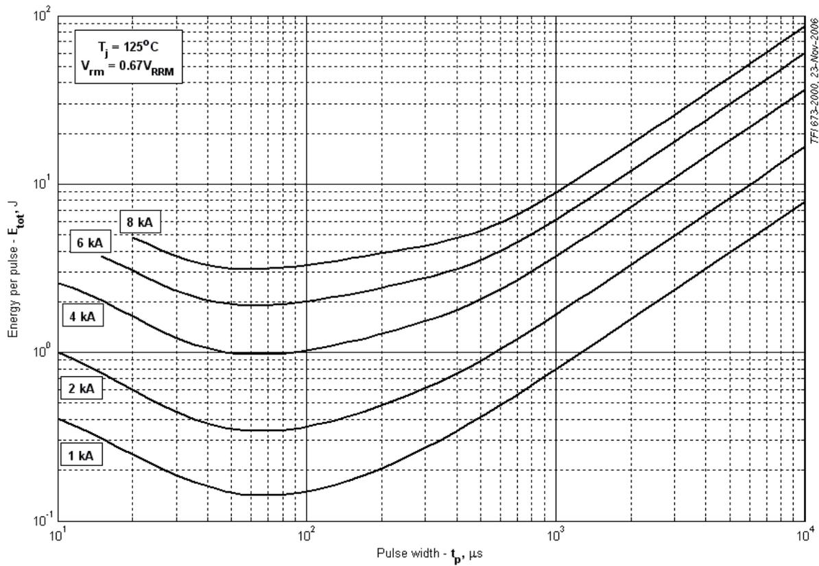
Рис. 9 – Суммарная энергия потерь одного синусоидального импульса тока
