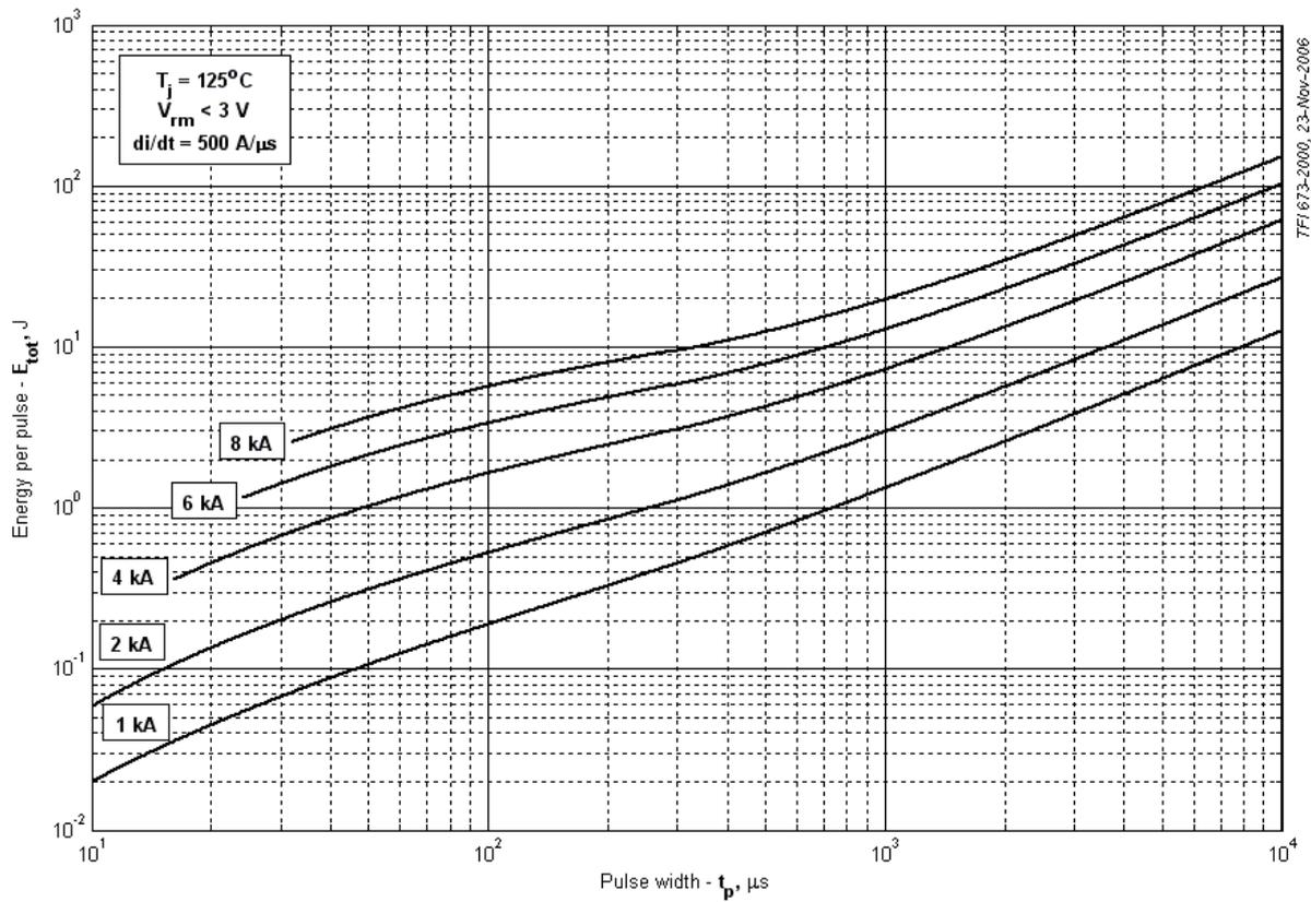
Рис. 19 – Суммарная энергия потерь одного прямоугольного импульса тока
