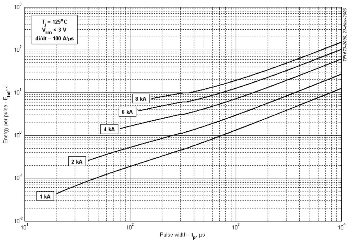
Рис. 18 – Суммарная энергия потерь одного прямоугольного импульса тока
