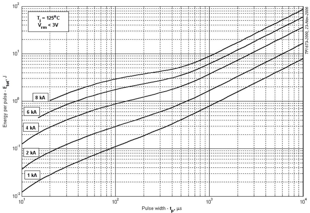
Рис. 8 – Суммарная энергия потерь одного синусоидального импульса тока
