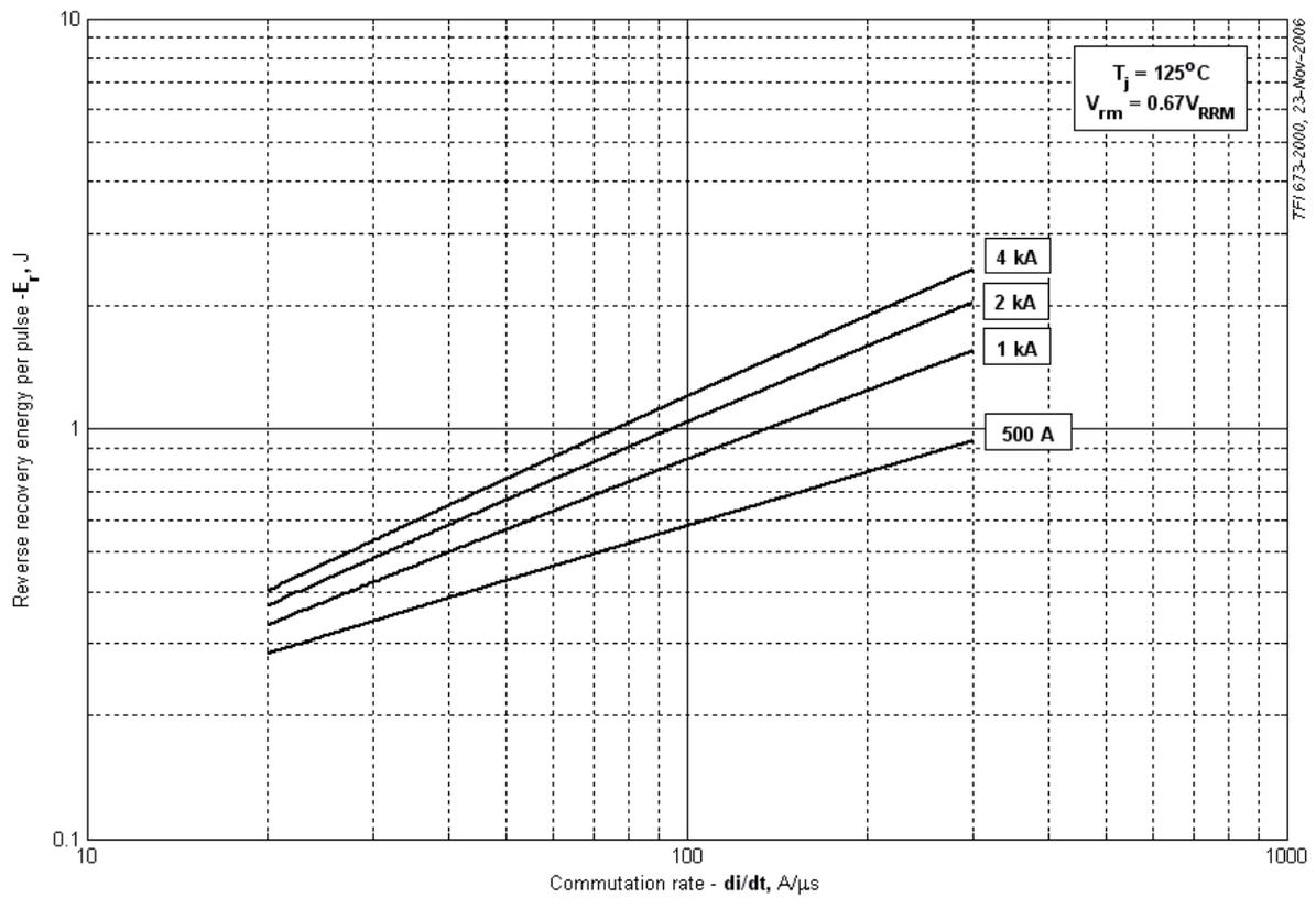
Рис. 7 – Энергия обратного восстановления за импульс
