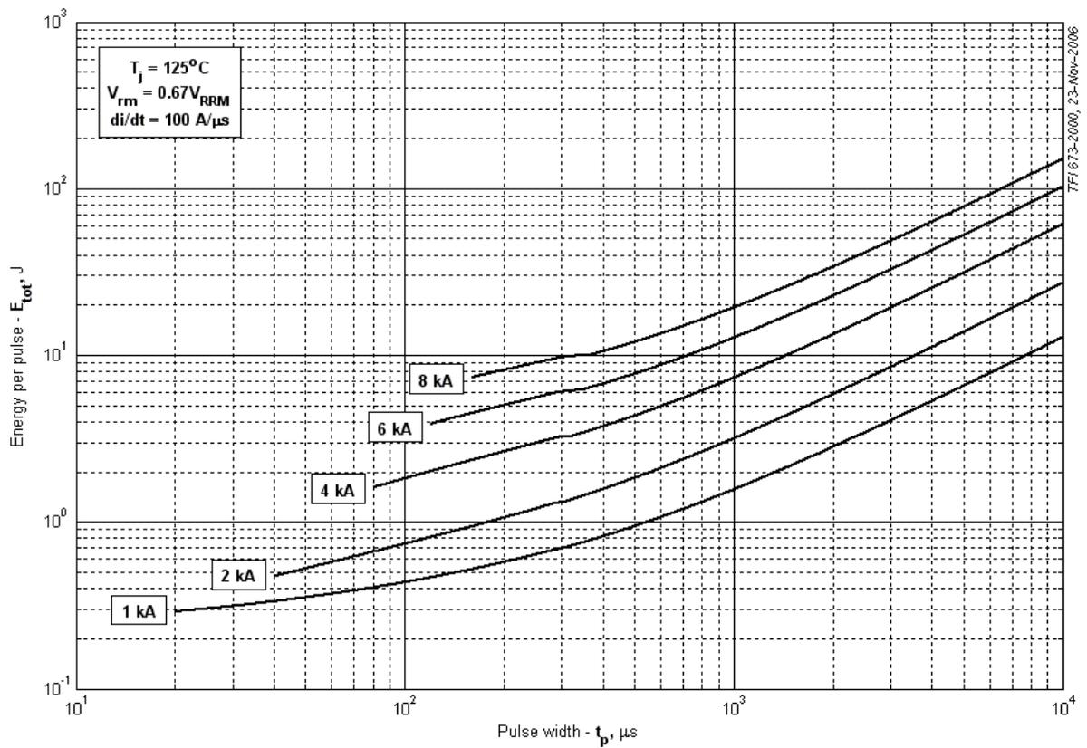
Рис. 24 – Суммарная энергия потерь одного прямоугольного импульса тока
