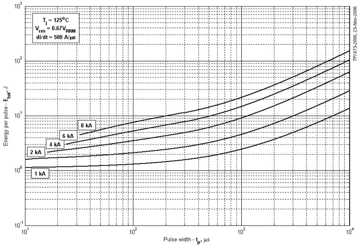
Рис. 25 – Суммарная энергия потерь одного прямоугольного импульса тока
