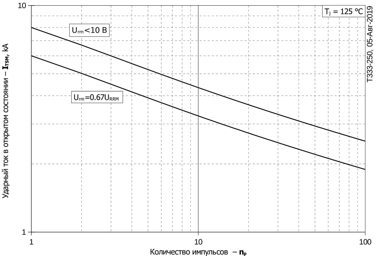
**Рис. 12 – Зависимость максимальной амплитуды ударного тока в открытом состоянии I<sub>TSM</sub> от количества импульсов n<sub>p</sub>**
