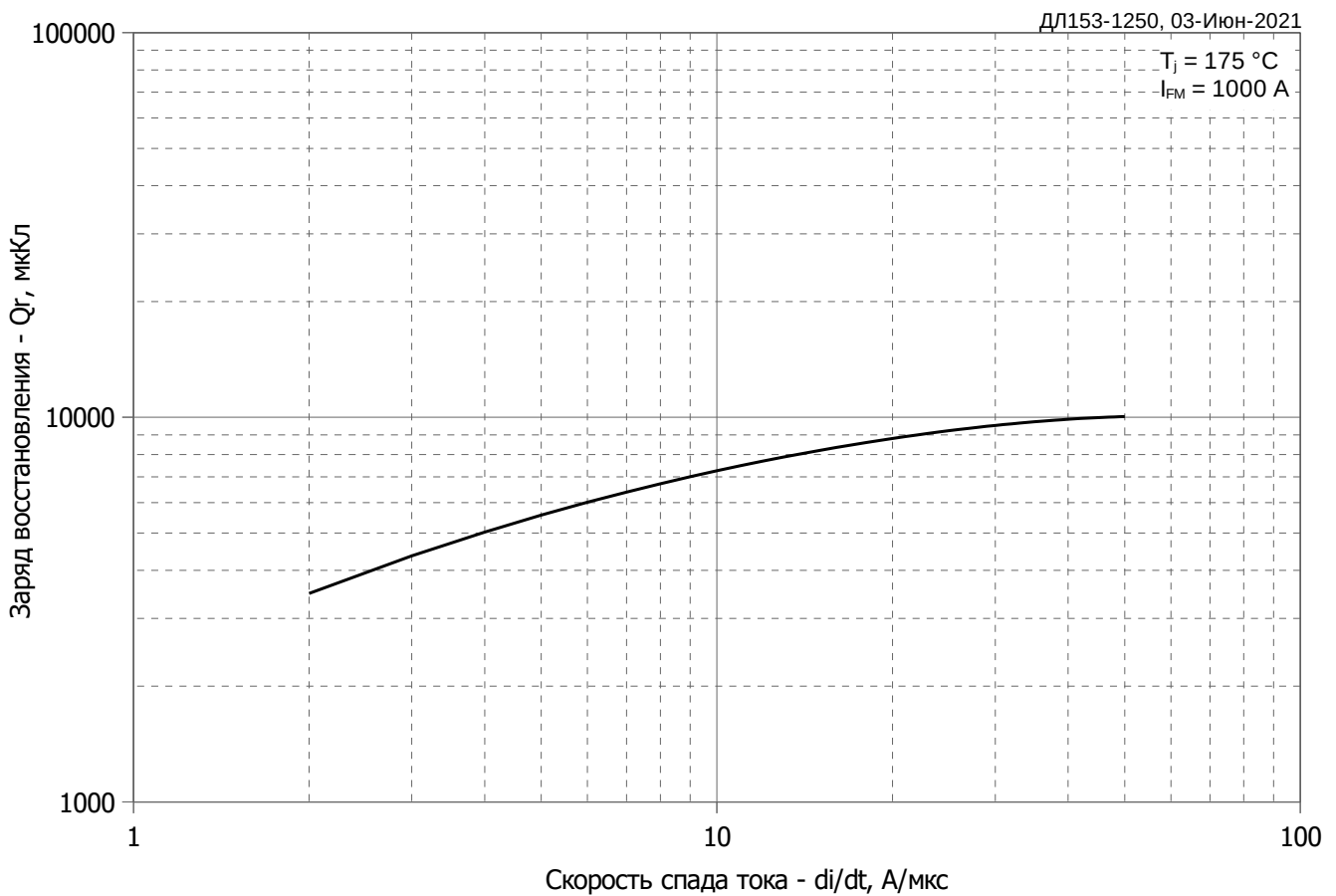
Рис. 4 – Зависимость максимального заряда восстановления Q_g от скорости спада прямого тока di_R/dt (по ГОСТ 24461, хорда 25%)
