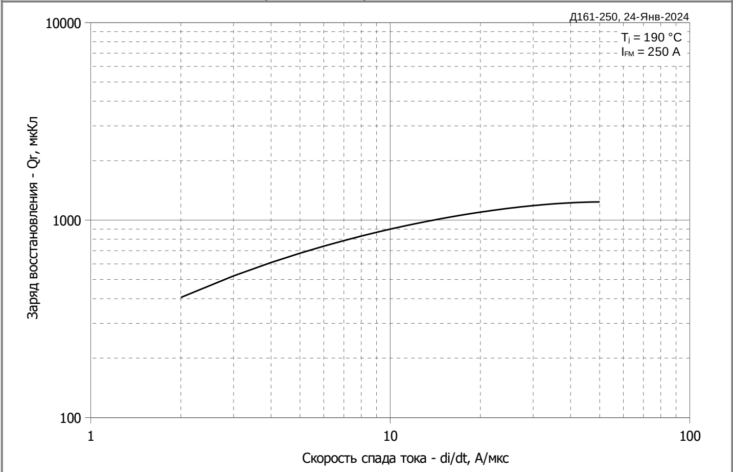
Рис. 4 – Зависимость максимального заряда обратного восстановления Q_r от скорости спада прямого тока di_R/dt (по ГОСТ 24461, хорда 25%)
