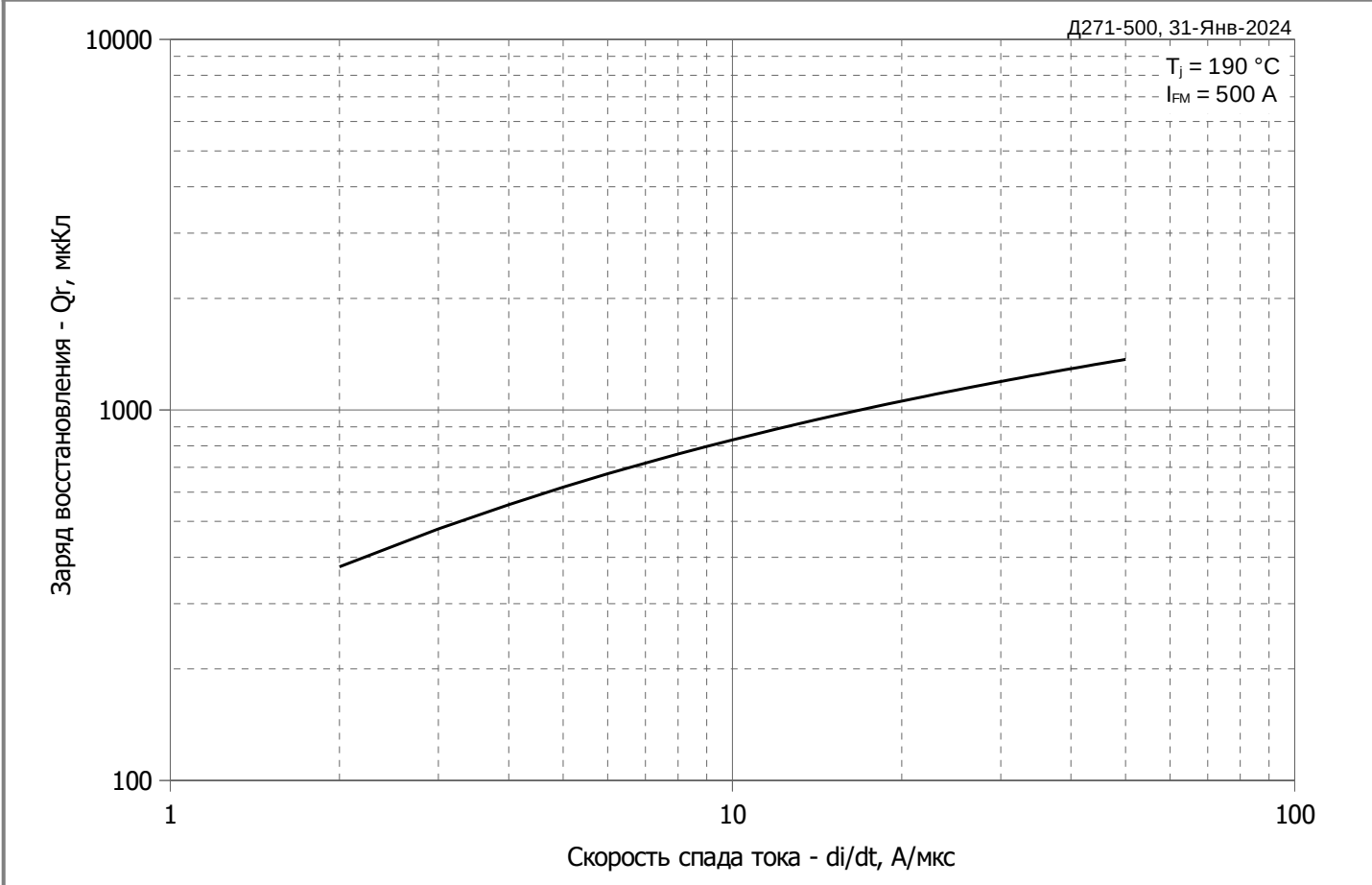
Рис. 4 – Зависимость максимального заряда восстановления Q_r от скорости спада прямого тока di_R/dt (по ГОСТ 24461, хорда 25%)
