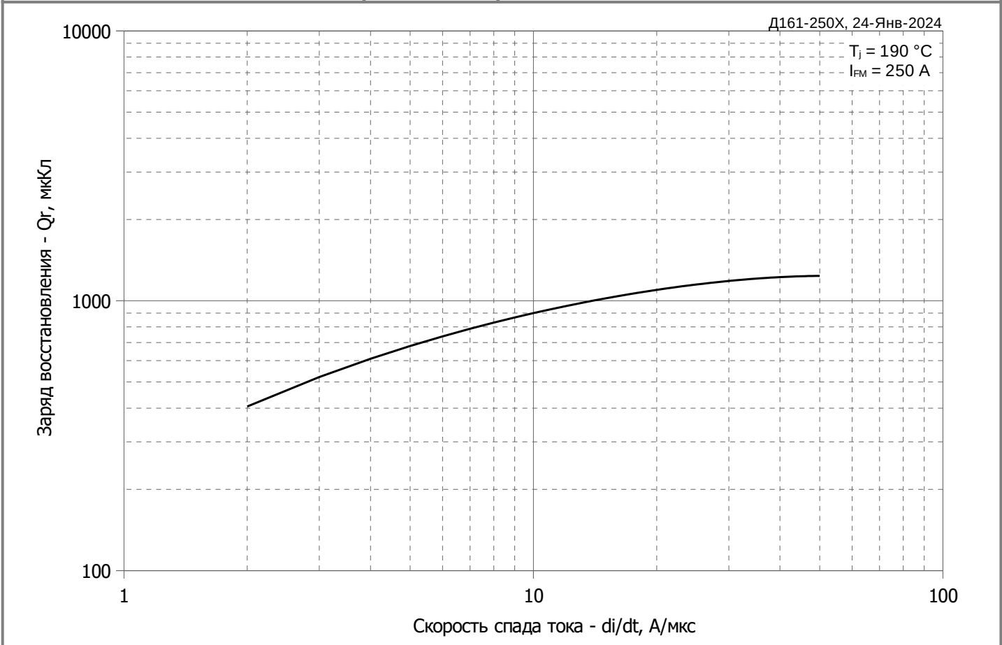
Рис. 4 – Зависимость максимального заряда обратного восстановления Q_{rr} от скорости спада прямого тока di_R/dt (по ГОСТ 24461, хорда 25%)
