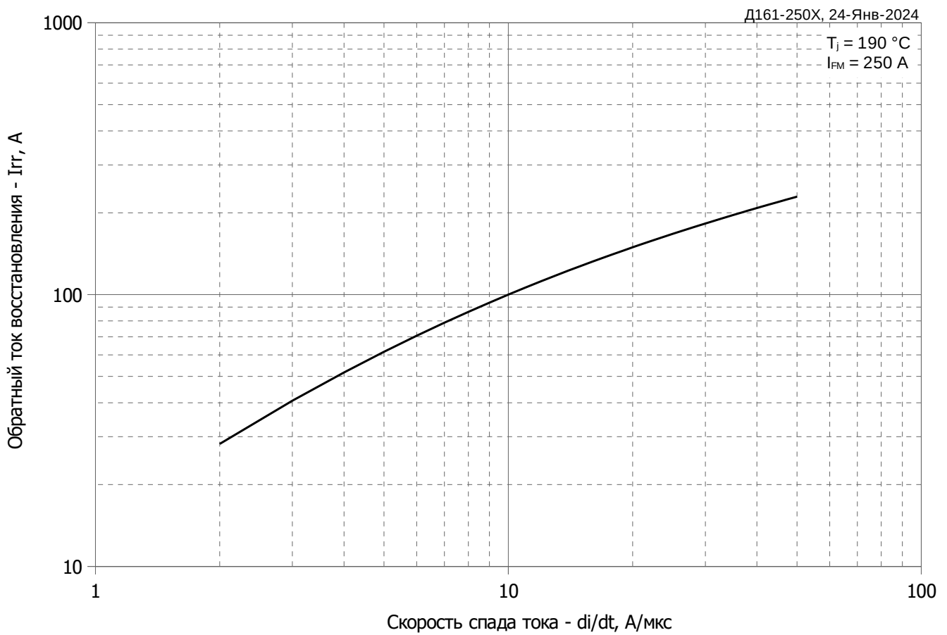
Рис. 5 – Зависимость максимального тока обратного восстановления I_{rrM} от скорости спада прямого тока di_R/dt
