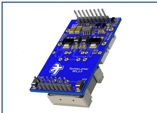
Тиристорный драйвер DT13-3.0-24-E-1 предназначен для управления силовыми тиристорами с номинальными токами от 160 до 5 000 А и классом по напряжению до 1800 В.
