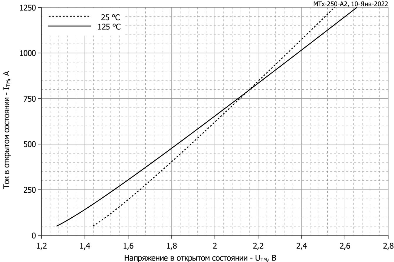
**Рис. 1 – Предельная вольт – амперная характеристика**
