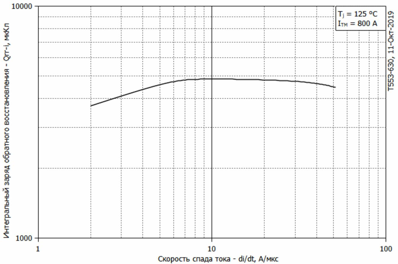
**Рис. 3 – Зависимость максимального интегрального заряда обратного восстановления Q<sub>rr-i</sub> от скорости спада тока di<sub>R</sub>/dt в открытом состоянии**
