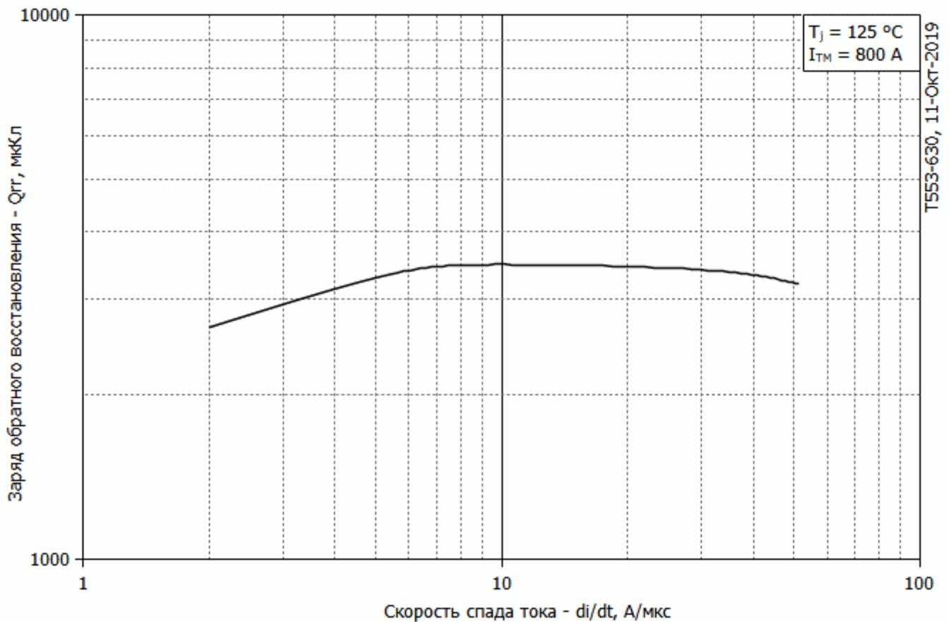
**Рис. 4 – Зависимость максимального заряда обратного восстановления Q<sub>rr</sub> от скорости спада тока di<sub>R</sub>/dt (по ГОСТ 24461, хорда 25%) в открытом состоянии**
