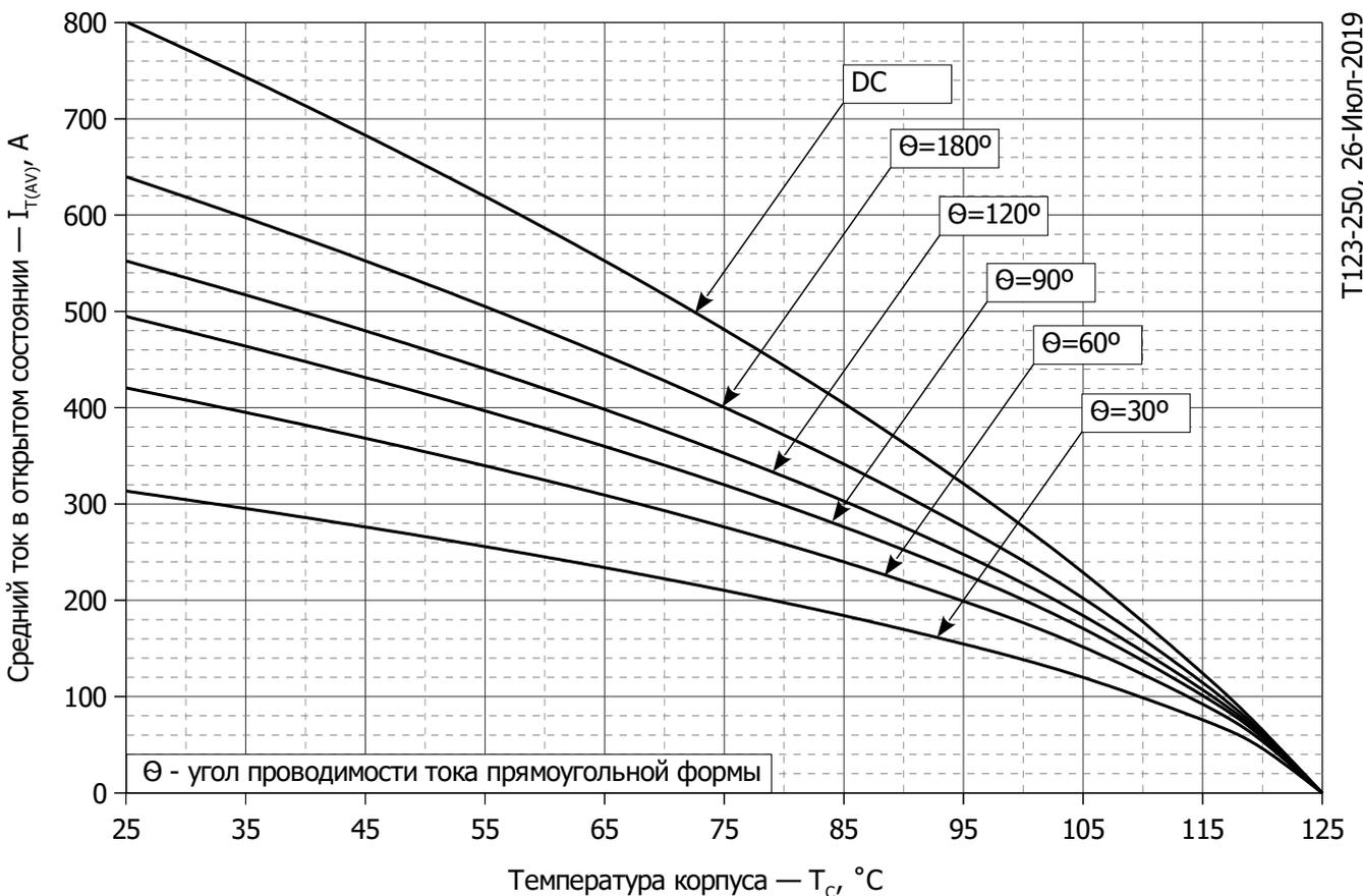
**Рис. 10 - Зависимость среднего тока в открытом состоянии  $I_{TAV}$  от температуры корпуса  $T_c$  для прямоугольной формы тока при различных углах проводимости ( $f=50$  Гц, двухстороннее охлаждение)**
