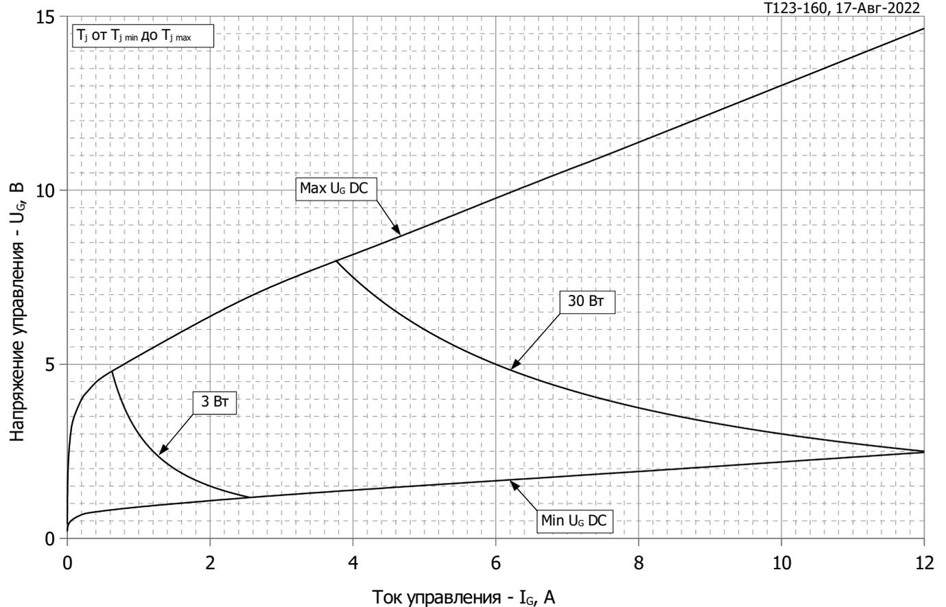
Рис. 4 – Вольт – амперная характеристика цепи управления – Кривые мощности
