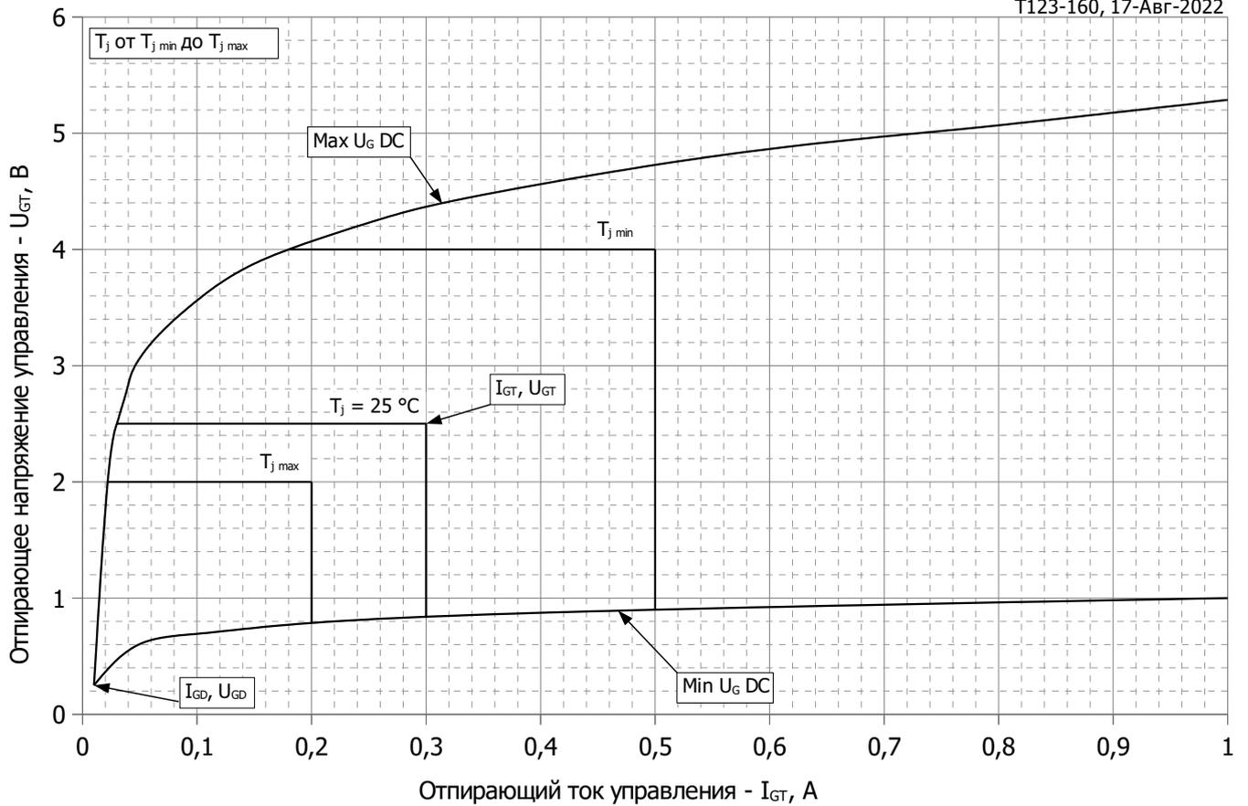
Рис. 3 – Вольт – амперная характеристика цепи управления
