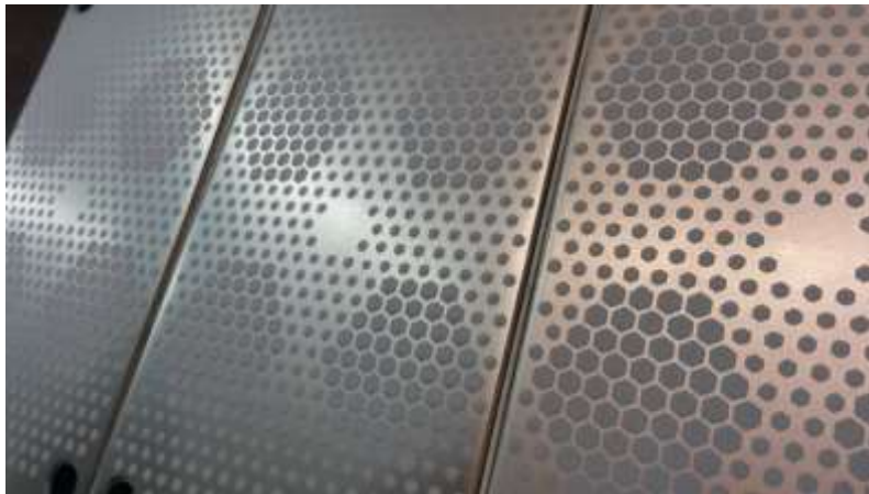
Рисунок 27. PCM нанесенный на модули MIAA при помощи трафарета.
