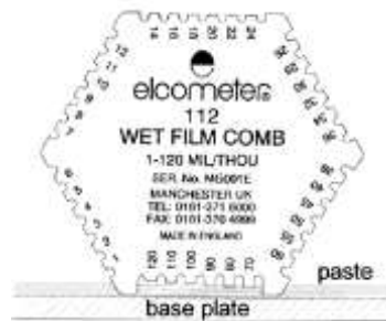
Рисунок 26. Гребешок для измерения толщины теплопроводящей пасты.
